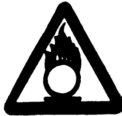
Warnung vor brandfördernden Stoffen
