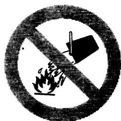
Verboden met water te blussen
